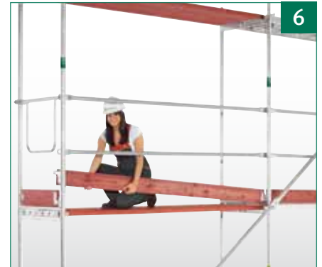
Vertikalrahmen und Beläge der nächsten Lage montieren, Diagonale, Geländer und Bordbretter einhängen.
